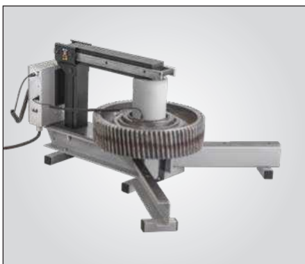
Figure 4: TIH L MB avec chauffage horizontal de la pièce à travailler
